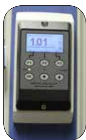
Устройство мониторинга воздушного потока в вытяжном шкафу
